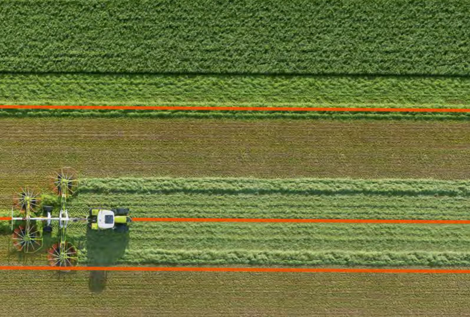
Der Einsatz der 4-Kreiselschwader erfolgt auf immer mehr Flächen. Die effektive Kostensenkung lässt sich jedoch durch Nutzung aller technischen Möglichkeiten noch weiter steigern. Der Einsatz von Lenksystemen ermöglicht z. B. die konstante Ausnutzung der maximalen Arbeitsbreiten und auch die ISOBUS Steuerung erlaubt eine komfortable Bedienung über die F-Tasten des Traktorfahrhebels.
