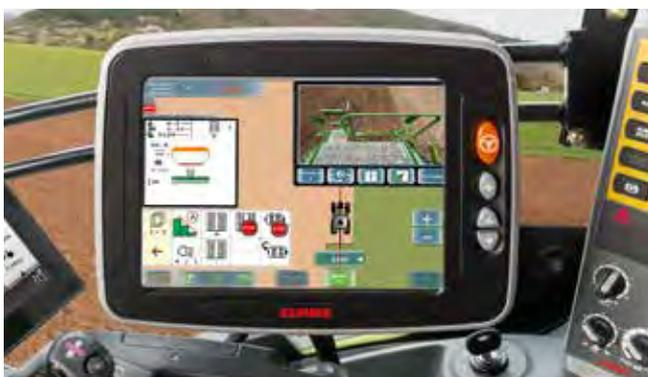
**In dem Feldeinsatz:** Einfach die in 365FarmNet erstellte Fahrspurplanung mit einem Auftrag auf dem S10 auf dem CLAAS Traktor öffnen. Die geplante Referenzspur kann sofort verwendet werden.
