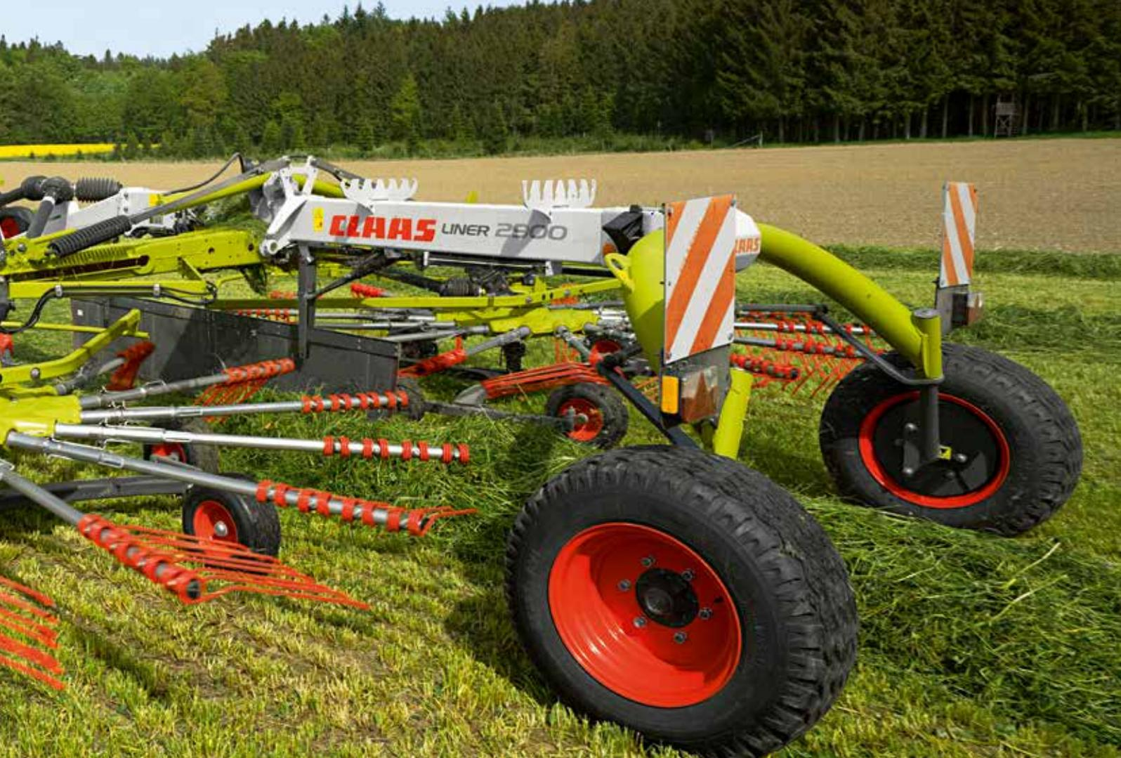
Neben leistungsstarker Technik und hoher Einsatzsicherheit ist die perfekte Zinken- und Kreiselführung das wichtigste Qualitätsmerkmal eines Schwaders. Die CLAAS Tandemachse beim Schwader ermöglichte bereits deutlich höhere Arbeitsgeschwindigkeiten und reduzierte den Schmutzeintrag deutlich. Mit der neuen Seitenschwadergeneration wird die Boden Anpassung des Kreisels und damit die Zinkenführung noch weiter perfektioniert.
