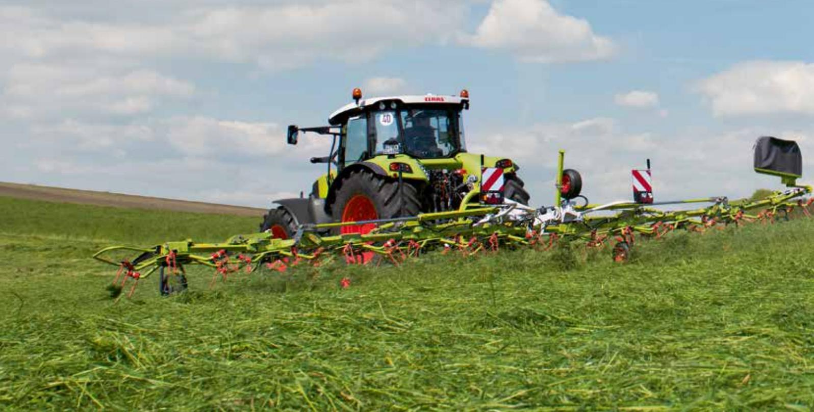
Zetten und Wenden bleibt bei hohen Erträgen zur Qualitätsfütterernte unverzichtbar. Die Herausforderung besteht darin, kompakte Maschinen mit hoher Leistung zu entwickeln. Beispiel VOLTO 1100: Der kompakt im Dreipunkt angebaute 10,70 m 10-Kreisel-Zettwender erreicht mit der neuen MAX SPREAD Technik die gleiche Flächenleistung wie bisher eingesetzte 13,00 m Maschinen mit klassischer Zinkenordnung.
