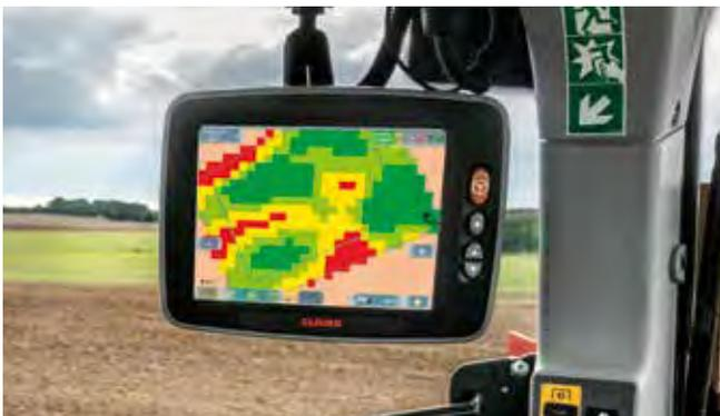
**In dem Feldeinsatz:** Die erstellte Applikationskarte auf dem S10 auf dem CLAAS Traktor starten und teilflächenspezifisch säen. So können auch nachts oder bei schlechten Sichtverhältnissen die richtigen Mengen appliziert werden.
